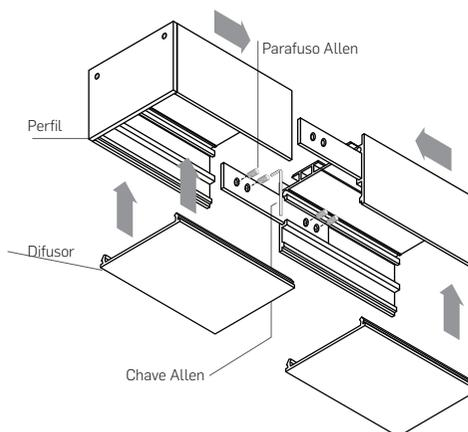
**MONTAGEM DO PERFIL COM EMENDA LINEAR**
